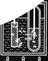
Natrium-Schwefel-Zelle der Firma Ford. Die Elektrolyten (E) wandern durch die Keramik. Die Elektronen (e-) wandern über die negative Elektrode.
