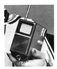
Fig. 1 Der kleinste an der Fera 1970 gezeigte Fernsehempfänger. Japanisches Gerät mit Batteriebetrieb und 4-cm-Bildschirm
