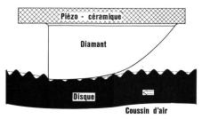
Principe de la piézo-lecture d'un disque vidéo se déformant élastiquement
