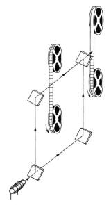
Fig. 8 Principe du transfert d'un film sous forme d'images interférentes sur un support, à l'aide d'un laser et d'une holographie bidimensionnelle
