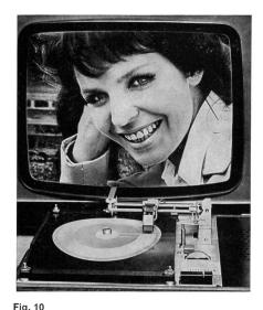
Fig. 10 Lecteur de disques vidéo AEG-Telefunken-Teldec, raccordé à un téléviseur
