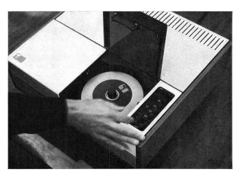
Fig. 6 Teleplayer (lecteur de film) pour système EVR, pour raccordement à un téléviseur
