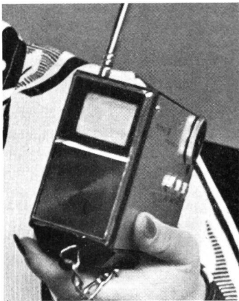
Fig. 1 Der kleinste an der Fera 1970 gezeigte Fernsehempfänger. Japanisches Gerät mit Batteriebetrieb und 4-cm-Bildschirm
