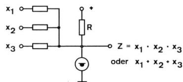
Der Logikvorgang wird durch die Umschaltung der Tunneldiode vom Nieder- zum Hochspannungszustand gebildet. Ob die Schaltung ein Und- oder ein Oder-Tor darstellt, wird durch den Strom durch R bestimmt. Bei einem Strom nahe des Spaltenstromes zeigen sich Oder-Eigenschaften, während sich bei einem sehr kleinen Strom die Und-Funktion zeigt. Günstig für sehr schnelle Schaltungen.
