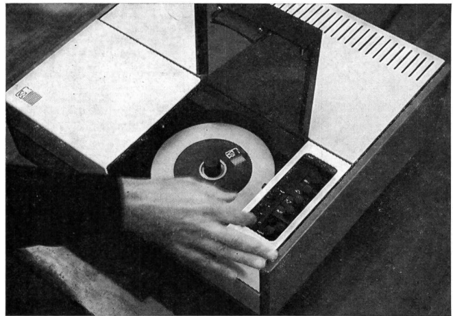
Fig. 6 Teleplayer (Filmabtaster) für EVR zum Anschluss an ein Fernsehgerät
