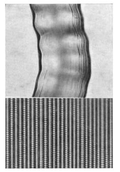
Fig. 9 Vergleich der Seitenschriftrille einer Schallplatte mit der frequenzmodulierten Tiefenschriftrille einer Bildplatte (unten)
