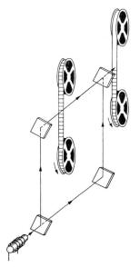
Fig. 8 Prinzip der Übertragung eines Filmes mittels Laser und zweidimensionaler Holographie auf eine Masterfolie als Interferenzbild
