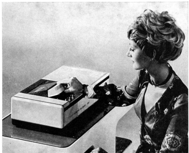
Fig. 3 Video-Kassettenrecorder mit eigenem Antenneneingang und Tuner
