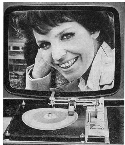
Fig. 10 Bildplattenspieler von AEG-Telefunken-Teldec, an ein Fernsehgerät angeschlossen
