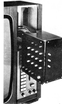
Fig. 3 Konvergenz-Regleinheit herausgezogen und ausgeklappt; sie bildet mit dem Lautsprecher (der in dieser Stellung nach unten liegt) eine Einheit
