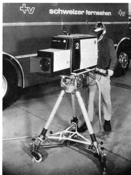
Fig. 15 Plumbikon-Farbkamera mit servogesteuertem Zoom-Objektiv (vorne). Der Kameramann beobachtet durch den Einblicktubus das elektronische Sucherbild; via Kopfhörer/Mikrophongarnitur ist er mit der Bildkontrolle (Technikwagen) und der Bildregie (Regiewagen) verbunden. Diese Gegenseitige Verbindung ist im Kamera-kabel enthalten, durch das die Kamera mit ihrem Hauptverstärker im Technikwagen verbunden ist
