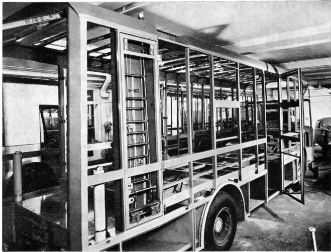
Fig. 3 Rechte Seitenansicht des Technikwagens. Die beiden Zylinder im Wagenheck enthalten hydraulische Stützen; seitlich ist der Einstieg (vorne) und der Leiterkasten (hinten) erkennbar Vue de droite de la voiture technique. Les deux cylindres visibles à l'arrière contiennent des béquilles hydrauliques; on voit en avant l'entrée de la voiture et en arrière le compartiment des échelles
