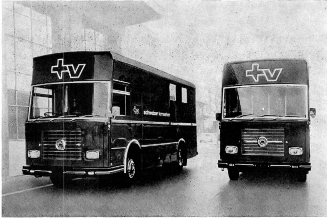
Fig. 1 Farbfernseh-Übertragungszug mit 4 Farbkameras, bereit zur Fahrt. Die umfangreichen Anlagen zur Bild- und Tonübertragung sind auf den Regiewagen (links) und den Technikwagen (rechts) verteilt. Train de reportage pour émissions de télévision en couleur, avec 4 caméras, prêt au départ. Les installations de transmission sont réparties entre la voiture de régie (à gauche) et la voiture technique (à droite)
