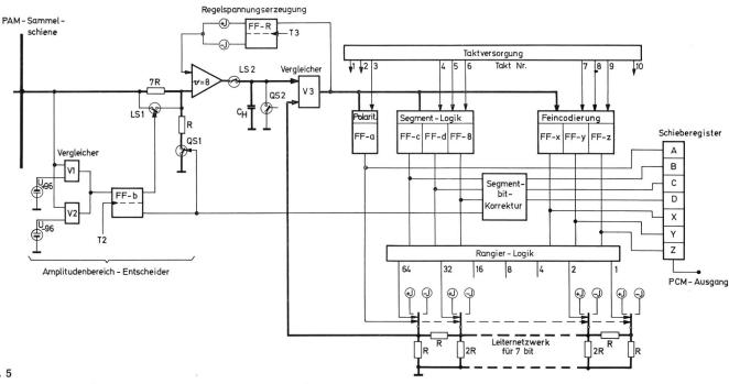
Fig. 5 Prinzipschema der Codiereinrichtung Speicherzellen gesteuert wird, schaltet die drei Feincodierflipflops X, Y und Z an die entsprechenden Gewichte.
