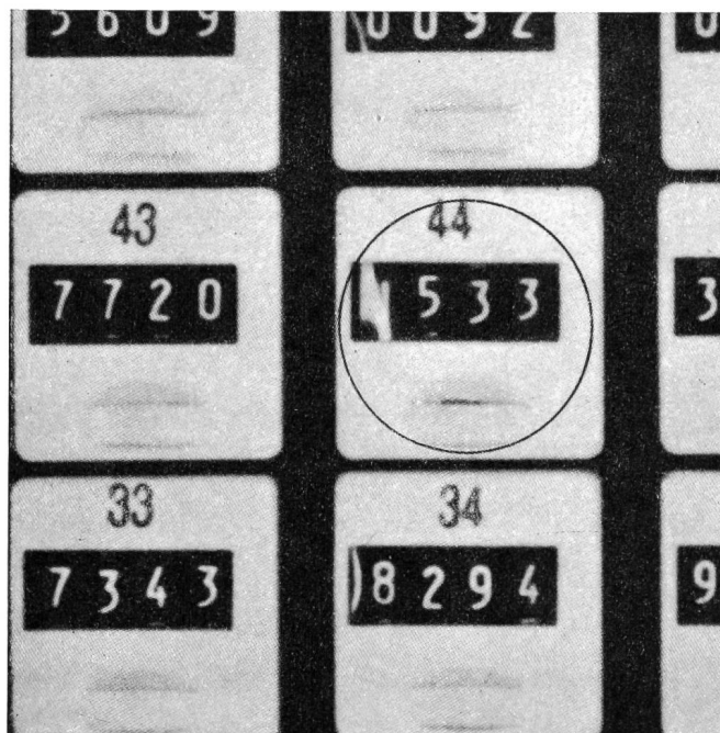
Fig. 4 Undeutlicher Zählerstand als Fehlerquelle
