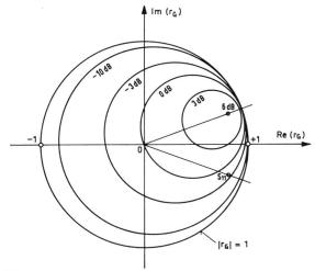
Fig. 16 Kurven konstanter Verstärkung  $\Gamma_{\rm G}$  in der r $_{\rm G}$ -Ebene für einen unilateralen Transistor mit s $_{11}=$  0,867  $<\!\!<$  - 20 °
