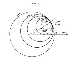
Fig. 13 Kreise konstanter Leistungsverstärkung g in der  $r_L$ -Ebene für den unbedingt stabilen Transistor 2 N 3570 bei 750 MHz (K = 1,033;  $\beta_1=0,253$ ;  $\beta_2=1,537$ )
