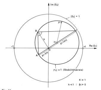
Fig. 11 Die Abbildung des Kreises  $|r_L|=1$  in der  $S_1$ -Ebene ergibt den Stabilitätskreis. Für unbedingte Stabilität muss dieser innerhalb des Einheitskreises  $|S_1|=1$  liegen und diesen nicht berühren
