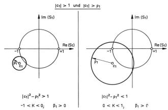
Fig. 12 Bedingte Stabilität. Lage der (dick ausgezogenenen) Stabilitätskreise in der  $S_1$ -Ebene für verschiedene Fälle
