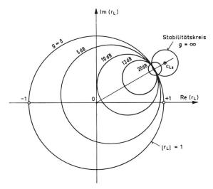
Fig. 15 Kreise konstanter Leistungsverstärkung g in der  $r_L$ -Ebene für einen potentiell unstabilen Transistor mit K = 0,91;  $\beta_1$  = 0,195;  $\beta_2$  = 1,483
