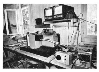
Fig. 4 Ausrüstung [zum Einblenden der Zeitmessung (Rennzeit) im Fernseh-Regieraum
