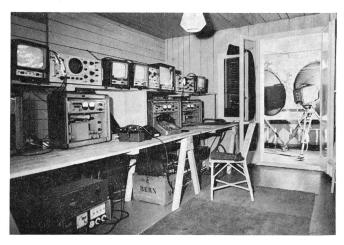
Fig. 9 Mobile Richtstrahlendausrüstung mit Parabolantennen zur drahtlosen Bedienung weit entfernter Fernsehaufnahmekameras
