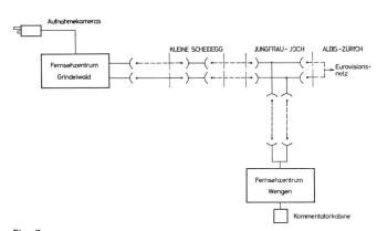
SDS-Rennen in Grindelwald. Übertragung des Bildes ins Eurovisionsnetz und nach Wengen in die Kommentatorkabinen
