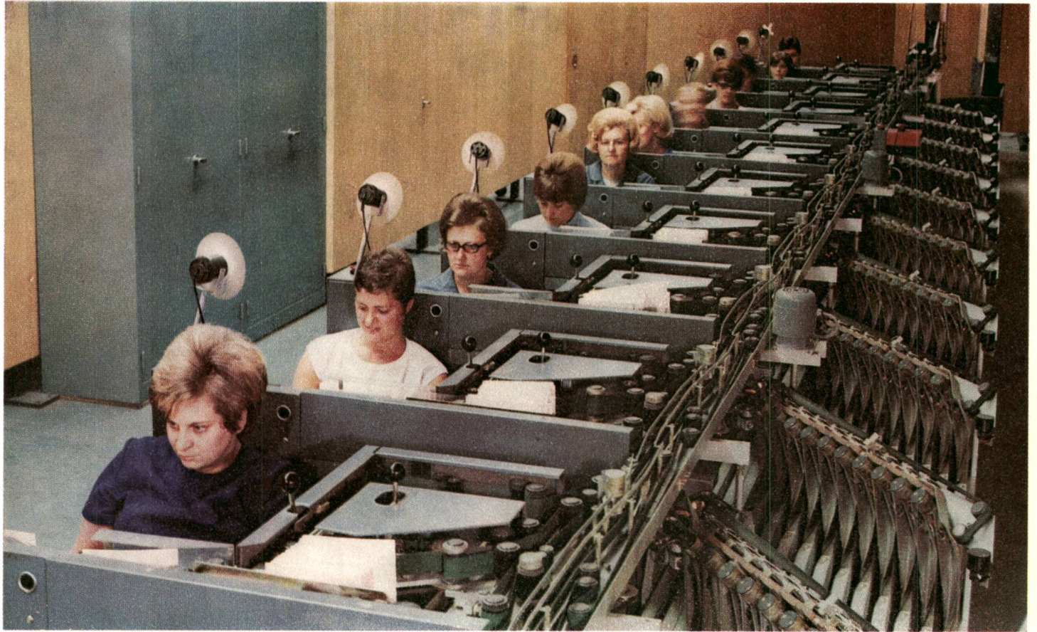
▲ Fig. 10 Codier- und Vorsortieranlage Installation de codage et de tri préliminaire
