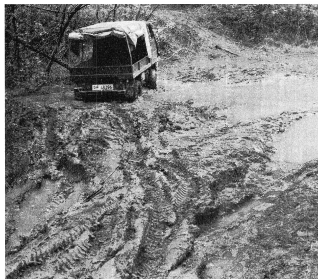
Fig. 4 Neue Probleme traten beim Befahren dieser Schlamm- und Wassertümpel auf, die nur bei richtig eingelegten Gängen und Sperrern zu meistern waren
