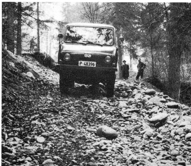
Fig. 3 Die Steigung auf dieser Geröllpiste beträgt 65%. Sie bildete eine der weitem Übungsmöglichkeiten
