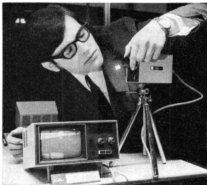
Fig. 3 Die kleinste Fernsehamera der Welt (aus Japan) mit einem ebenfalls sehr kompakt gebauten Monitor-Fernsehempfänger
