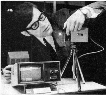
Fig. 3 Die kleinste Fernsehkamera der Welt (aus Japan) mit einem ebenfalls sehr kompakt gebauten Monitor-Fernsehempfänger
