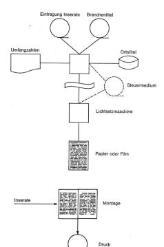
Ablaufschema der Herstellung des Branchen-Telephonbuches PTT mit Hilfe der elektronischen Datenverarbeitung
