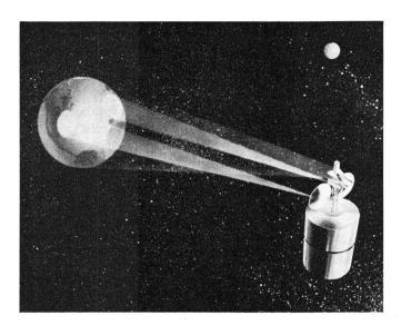
Diese Zeichnung zeigt die Strahlenkegel der verschiedenen An-tennensysteme von Intelsat IV: zwei scharf gebündelte und zwei die ganze sichtbare Erdoberfläche bestrahlende
