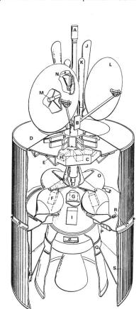
Schnitt durch den Intelsat IV. Die von der Contraves gebauten Einzelsysteme H und I befinden sich unterhalb der Antennen beziehungsweise im Zentrum des Satelliten
