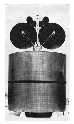
Modell des Intelsat IV. Die beiden Parabolantennen sind scharf bündelnd, dahinter die Sende- und Empfangsantennen für ein erdweites Strahlungsfeld
