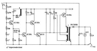
Fig. 2 Schema des Ableiterprüfgerätes
