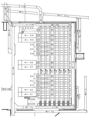
Fig. 5 Disposition der neuen Paketverteilanlage mit den Zufuhrbandstrassen (7, 7a, 7b, 7c, 7d, 7e, 4, 4a, 5, 8 und 10), den sieben Verteilbändern (V1...V7), den Querbändern (Q1...Q15) und den zwölf Rutschen (R1...R14)
