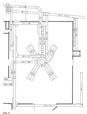
Disposition der alten Paketverteilanlage mit den Zufuhrbandstrassen (7a, 7b, 7c, 4, 4a, 5, 8 und 10), den Anschreiberplätzen (zwischen Band 4b und 4d), dem Drehtisch (21) und den Rutschen
