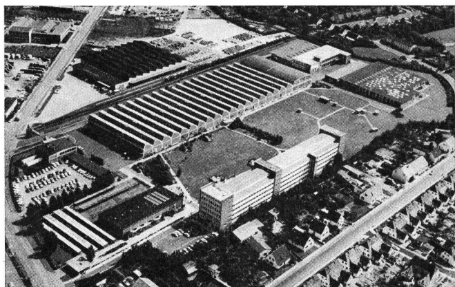
Fig. 1 Luftaufnahme des Nordmende-Industrieareals an der Funkschneise in Bremen-Hemelingen. Der langgestreckte Shedbau beherbergt auf über 17 000 m 2 das Fernsehwerk (mit einer Tagesproduktion von über 1000 Stück) sowie die Nebengebäude für Tunerbau und -prüffeld. Unten im Bild der Bau, der das Entwicklungszentrum (5000 m 2 ) und die Verwaltung beherbergt. Ausserhalb liegen das Rundfunkwerk sowie die Zweigwerke Wildeshausen und das diesen Sommer die Produktion aufnehmende Werk Bremerhaven (20 000 m 2 )
