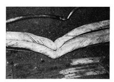
Fig. 3 Zerdrücktes Kabel 1200  $\times$  2 und gereinigtes Stammkabel 400  $\times$  2, das ganz neu gespleisst werden musste
