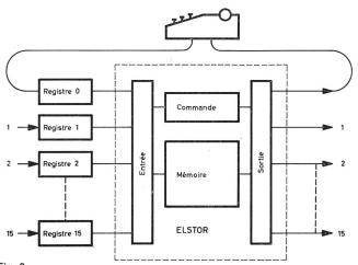
Fig. 6 Schéma bloc d'une mémoire intermédiaire Elstor
