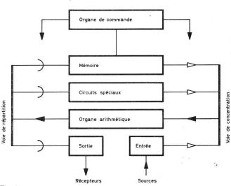
Fig. 4 Schéma bloc d'un petit calculateur
