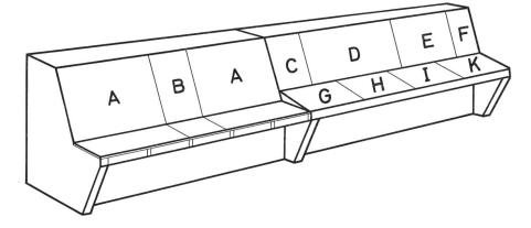
électrique. En E, un schéma synoptique représente la structure du réseau qui alimente le centre ATECO. Ce schéma contient les relais de télécommande des disjoncteurs (situés au sous-sol) avec leurs indicateurs de position, les lampes de signalisation des alarmes pouvant avoir lieu dans le système d'alimentation ainsi que deux interrupteurs de secours au moyen desquels tout le centre peut être déconnecté en cas de grave danger.
