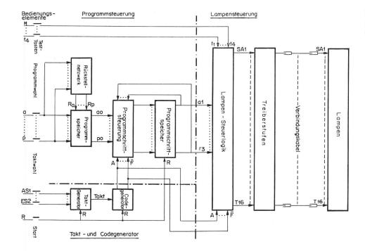
Fig. 3 Blockschaltbild der elektronischen Steuerung.
