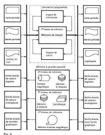
Structure hiérarchique d'une installation de traitement de données. Les données et les programmes sont enregistrés dans des niveaux de mémoire différents selon la capacité nécessaire, les conditions d'accès ou leur actualité. L'entrée et la sortie des données ont lieu sur des voies de concentration selon le principe du multiplex dans le temps (asynchrone)
