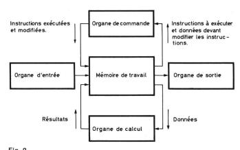
Schéma de principe d'une calculatrice programmée. Sur deux boucles différentes et en provenance de la mémoire de travail, les instructions (programme) sont interprétées et les données arithmétiques ou logiques sont traitées de façon correspondante. Les organes d'entrée et de sortie comprennent l'ensemble des appareils périphériques
