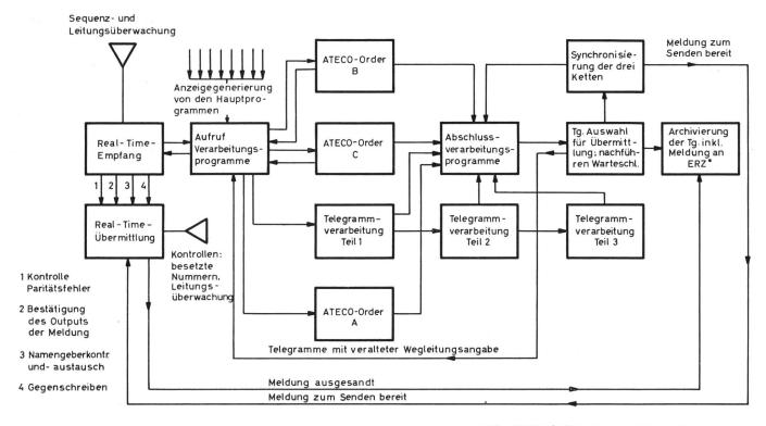
Fig. 19 Übersichtsdiagramm synchronisierter Ablauf des Real-Time-Systems
