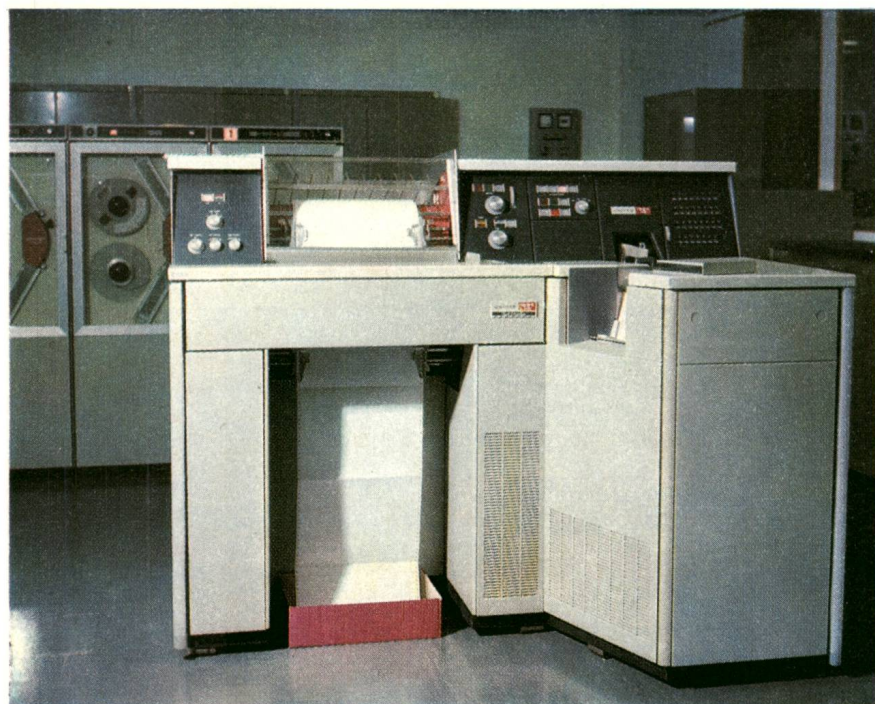
Fig. 9 Satelliten-Einheit 1004 mit Magnetbandspeicher Ordinateur périphérique 1004 avec mémoires à bandes magnétiques
