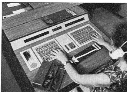
Fig. 2 Schnurloses Vermittlerpult für Blindenbedienung. In der Mitte oben der optische Nummernanzeiger, der für die blinde Telefonistin noch nicht «sichtbar» ist. Auf dem Pult ein Papierstreifen, der aus dem Schreibapparat links stammt, mit dem in Blindenzeichen die Notizen eingestanzt werden
