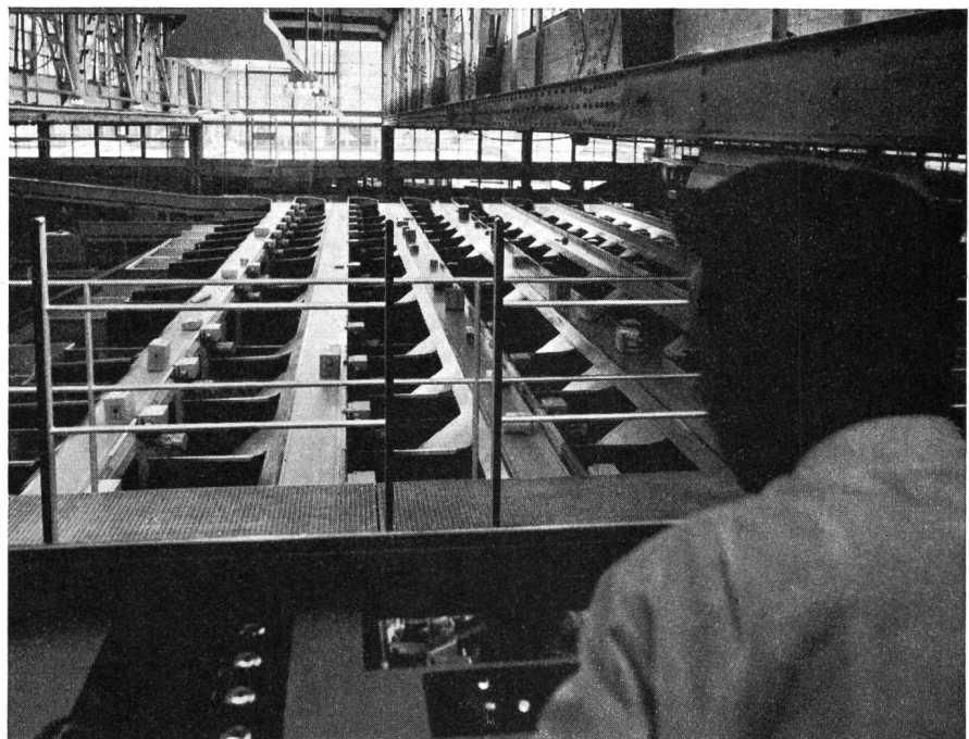
Fig. 4 Blick vom Überwachungsplatz (mit Fernsehen) auf die sieben Verteilbänder mit ihren 91 elektromechanischen Abweisern und Rutschen. Quer zu den hier sichtbaren Verteilbändern verläuft eine Anzahl Sammel- und Querbänder, die den darunter liegenden Raum zum Umlad der Pakete besser auszunutzen gestattet
