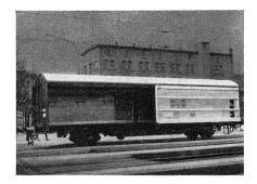
Fig. 6 Zweiachsiger Postgüterwagen mit Schiebewänden für den Transport von Rollbehältern
