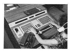
Fig. 2 Schnurloses Vermittlerpult für Blindenbedienung. In der Mitte oben der optische Nummernanzeiger, der für die blinde Telephonistin noch nicht «sichtbar» ist. Auf dem Pult ein Papierstreifen, der aus dem Schreibapparat links stammt, mit dem in Blindenzeichen die Notizen eingestanzt werden
