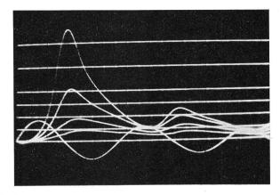
Fig. 6 Beispiel einer Kopplungsimpedanzmessung an einem Kabel 40  $\times 2$   $\times 1$  mm (aussenarmiert, Nennbelastung 2,5 C) i: Stossstrom (t $_{\rm \bar{a}q}=293~\mu \rm s,~f=1,1~kHz),~gedämpfte~Schwingung;~u: Längsspannung~bei einem Scheitelwert~des~Stromes~von~4,1/8,2/10,3/16,4~kA,~entsprechend~einer~Ladung~von~Q=1,2...4,8~C;$
