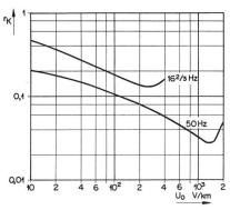
Fig. 8 Reduktionsfaktor des Kabels  $100\times2\times0.8$  bei 16 3/3 und 50 Hz. Der Absolutwert des Reduktionsfaktors lässt sich mit kleinem Aufwand stark senken (besser leitender innerer Schirm). Beachtlich ist der hohe Sättigungseinsatz bei  $U_0>1500~V/km~(50~Hz)$
