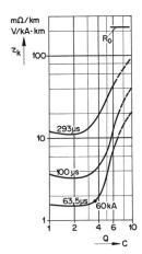
Fig. 7 Kopplungsimpedanz des Kabels  $40\times2\times1,0$  mm, 2,5 C-Typ, unter anderem Auswertung von Figur 6.  $R_o$ : Gleichstromwiderstand
