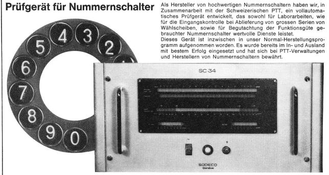
Automatische Messung der Gesamtablaufszeit von 10 Impulsen • Messung der Dauer jedes einzelnen Impulses und automatische Berechnung der zulässigen Toleranzgrenzen 🖜 Kontrolle der Hilfskontakte ● Leicht ablesbare Anzeige durch Leuchtfelder ● Hochpräzise Zeitmessung mit Quarzoszillator.
