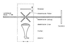
Fig. 18 Schema einer Messleitung für die dielektrische Leitung [28, 32]
