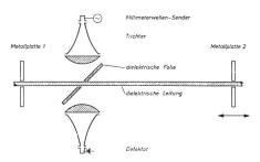
Fig. 20 Resonatoranordnung für die dielektrische Leitung, schematisch [28, 32]
