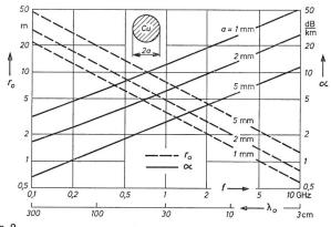
Grenzradius (---) und Dämpfung (----) der Sommerfeld-Welle für Kupferdrähte von verschiedenem Radius in Abhängigkeit von der Frequenz
