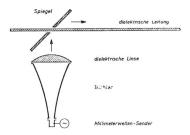
Fig. 15 Verfahren zur Anregung der HE,,-Welle auf einer dielektrischen Leitung [28]
