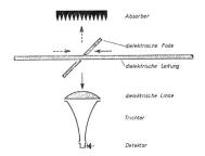
freiheit erreichen, indem man die Leitung in eine Pyramide oder einen Kegel aus absorbierendem Material auslaufen lässt, wozu man zum Beispiel Holz verwenden kann.
