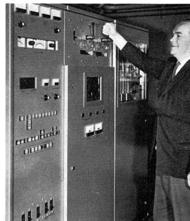
Fig. 7 Der mit einer Wanderwellenröhre ausgestattete Sender hat 10 kW Leistung bei einer Bandbreite von 500 MHz
