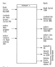
Fig. 1 Blockschema des Pentaconta-Fernamtes 4 Die Zahlen geben die Leitungen im Endausbau im Jahre 1970 an; sind zwei Zahlen angeführt, so entspricht die erste dem Stand vom 11. April 1968
