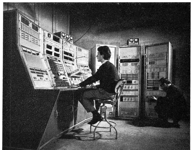
Fig. 9 Kontroll- und Steuerpult für die zweite Antennenanlage Goonhilly Downs
