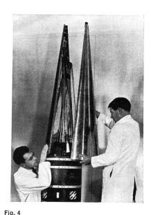
Spitze einer Skylark-Höhenrakete (mit gefalteten Dipolen), die in einer Höhe von 65 bis 80 km nach Absprengung der Verschalung in Arbeitsstellung ausgeklappt werden
