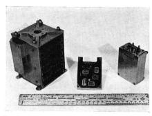
Fig. 5 Schaltkreise in Dünnfilmtechnik (Mitte), links und rechts mit solchen aufgebaute Messwertübertrager für Satelliten
