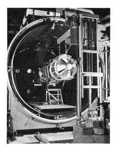
Fig. 8 Raumprüfkammer des Royal Aircraft Establishment in Farnborough anlässlich der Versuche mit dem Ariel-3-Satelliten
