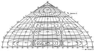
Fig. 13 Extremwert 25,22 Gewinn über Kugelstrahler 22,38 dB
