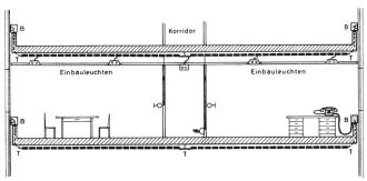
Fig. 60 Leitungsführung in einem Normalgeschoss
