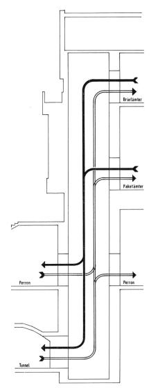
Fig. 51 Anordnung der Türen bei den Perron-Aufzügen
