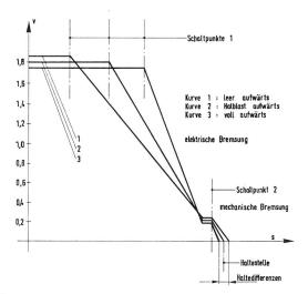
Fig. 49 Schaltpunktverschiebung (Transdyna-Steuerung)
