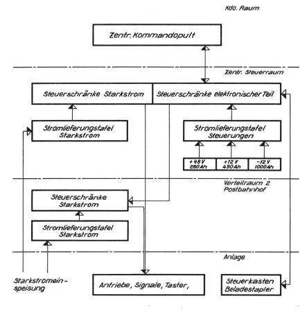
Fig. 38 Prinzipschema der Steueranlagen
