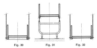
Normalkonstruktion Bandstrassen für Sackstücke. Fig. 30 Ausführung hängend mit unterer Tragrolle, Fig. 31 Ausführung stehend mit Schleifbügel, Fig. 32 Ausführung hängend mit Schleifbügel
