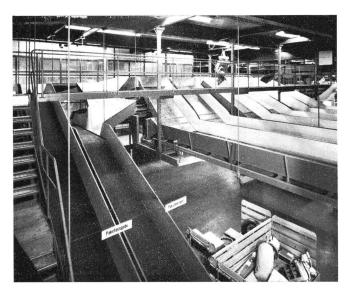
Fig. 22 Paketstapler Beladeanlage
