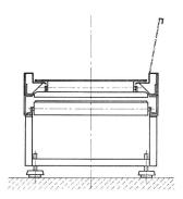
Fig. 26, 27 und 28 Normalkonstruktion Bandstrassen mit obern und untern Tragrollen für Pakete und Säcke
