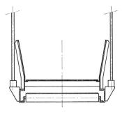
Fig. 29 Normalkonstruktion Bandstrassen mit Schleifboden für Steigungen von  $\geq$  20  $^{\rm o}$
