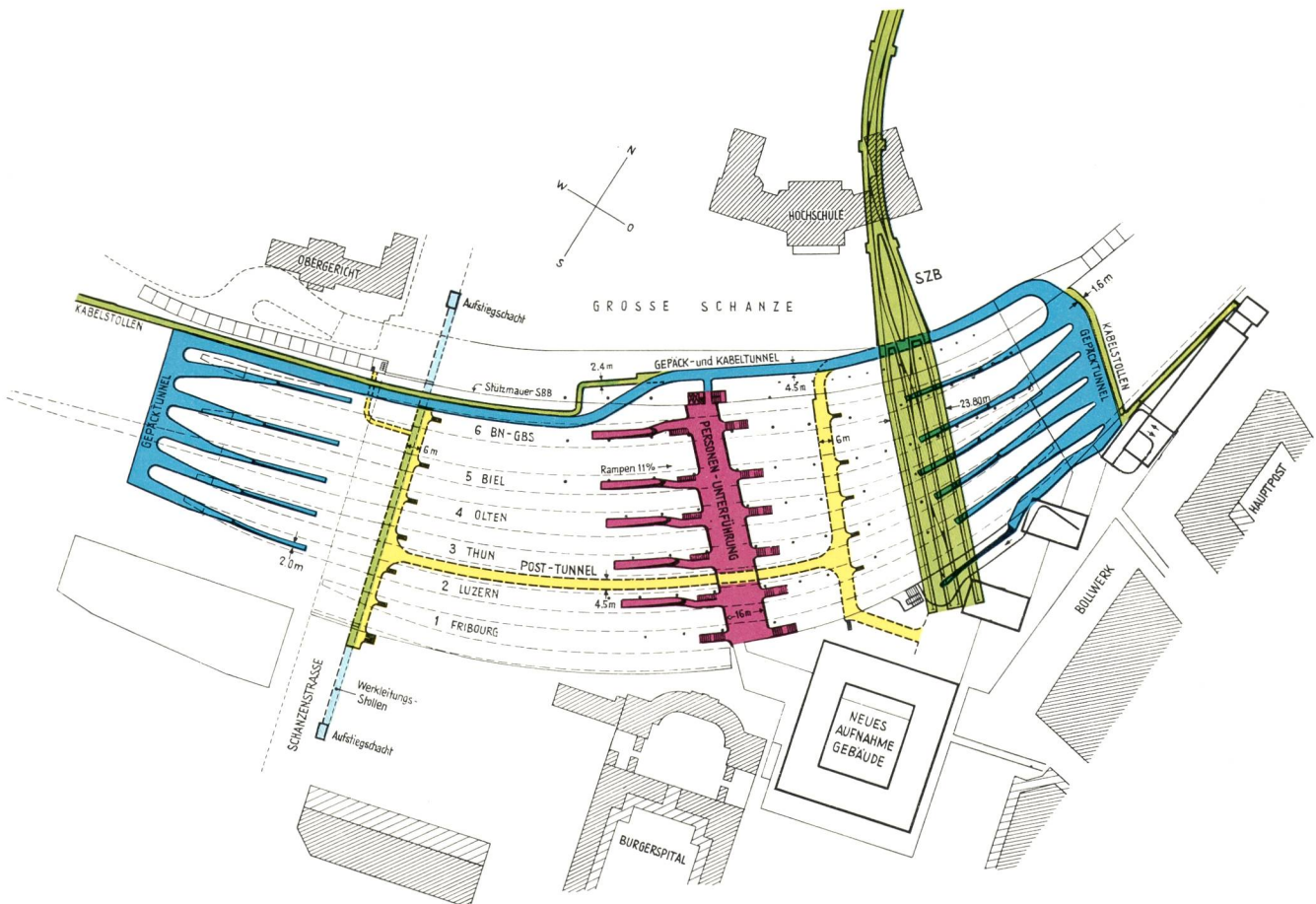
Fig. 5 ▼ Tunnelsystem unter den Gleisanlagen des neuen Personenbahnhofes Bern. Gelb: Posttunnels Système de tunnels sous les voies de la nouvelle gare aux voyageurs de Berne. En jaune: tunnels postaux
