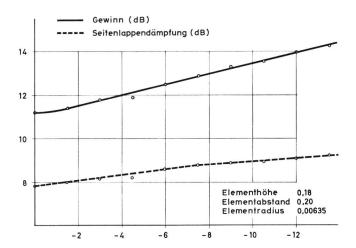
Fig. 6 Gewinn (dB) und Seitenlappendämpfung (dB) für einen belasteteten Yagi-Uda-Strahler als Funktion des Lastwiderstandes
