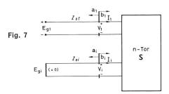
man das Ergebnis von Youla [13], wonach ein beliebiges verlustloses reziprokes 2n-Tor als Kaskade von drei 2n-Toren dargestellt werden kann. Zwei davon sind 2n-Tor-Allpässe, das andere ist eine Gruppe von n entkoppelten idealen Transformatoren. Für die Allpässe gilt:
