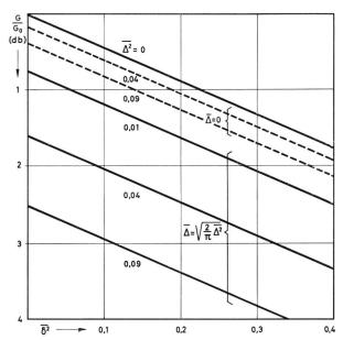
Fig. 10 Verminderung des Antennengewinns von Flächenantennen durch statistische Phasenfehler mit dem quadratischen Mittelwert  $\overline{\delta^2}$  und statistische Amplitudenfehler mit verschiedenen Mittelwerten  $\overline{\Delta}$  und quadratischen Mittelwerten  $\overline{\Delta}^2$  [17]
