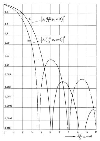
Fig. 9 Strahlungsleistung als Funktion des Winkels  $\vartheta$  von der Hauptstrahlrichtung kreisförmiger Aperturen. Kurve a für konstante Strahlungsdichte der Apertur (F  $(\varrho)$  = 1), Kurve b für F  $(\varrho/\varrho_0)$  = 1 –  $(\varrho/\varrho_0)^2$
