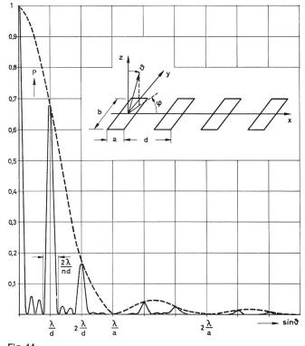
Fig. 14 Eine Gruppe von rechteckigen Flächenstrahlern in der x-y-Ebene angeordnet und ihre Strahlungsleistung als Funktion des Winkels  $\vartheta$  (ausgezogene Kurve), die als Produkt der Interferenzfunktion und des Beugungsbildes der Einzelapertur entsteht und für  $\varphi=0$  dargestellt ist. Es wurde n = 4 und d = 3a gewählt
