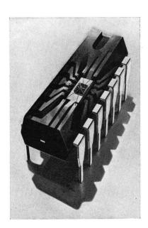
Integrierter Schaltkreis. In dieser mit Kunstharz vergossenen Ausführung erkennt man den verhältnismässig kleinen integrierten Schaltkreis mit den Anschlüssen zu den Kontaktstiften Circuit de connexion intégré. Dans cette exécution en matière plastique, on distingue le circuit intégré, de dimensions plutôt réduites, avec les raccordements aux broches de contact
