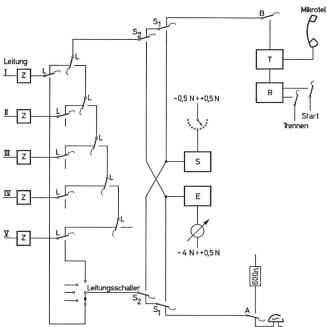
Fig. 2 Schaltungsaufbau des Verbindungsprüfgerätes Connexions du dispositif d'essai
