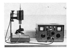
Fig. 2 Einrichtungen zur mechanischen Prüfung von Bügeleisen. Links Fallapparat, mit dem der Prüfling 1000mal 4 cm fallengelassen wird, rechts Steuergerät mit Kontroll- und Zähleinrichtung
