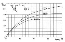
Fig. 11 Überschlagspannung zwischen zwei Kugeln von 20 mm ∅ (Temperatur 21° C, Barometerstand 722 mm Hg)
