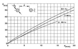
Fig. 12 Überschlagspannung zwischen zwei Kugeln von 50 mm  $\varnothing$  (Temperatur 21° C, Barometerstand 722 mm Hg)
