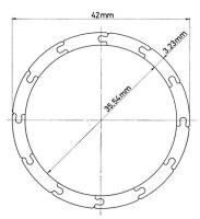
Fig. 9 Hohlseil in Cu oder Al der Vereinigten Deutschen Metallwerke, Frankfurt/Main, mit 12 Adern und 400 mm² Querschnitt, grösste Lieferlänge 1200 m, Gewicht pro km 3640 kg Cu beziehungsweise 1100 kg Al, Seilbruchlast 14 750 kg Cu oder 5040 kg Al
