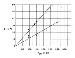
Kurve 2: Zweidraht-Feeder mit denselben Kupferdrähten,  $h = 43 \cdot 10^{-4} \left( \frac{W}{cm^2 \circ C} \right).$
