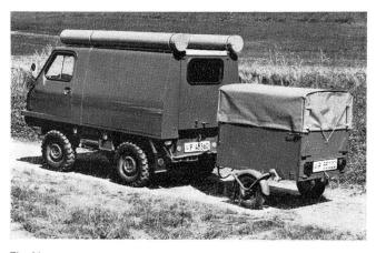
Fig. 31 Geländegängiges Fahrzeug («Haflinger») für Kleinkoaxialkabel-Spleissgruppen. Der Anhänger enthält die Ausrüstung zur Signalisierung von Baustellen an Strassen
