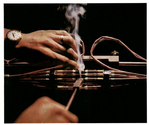
Kleinkoaxialkabel-Spleissung. Löten eines Innenleiters
