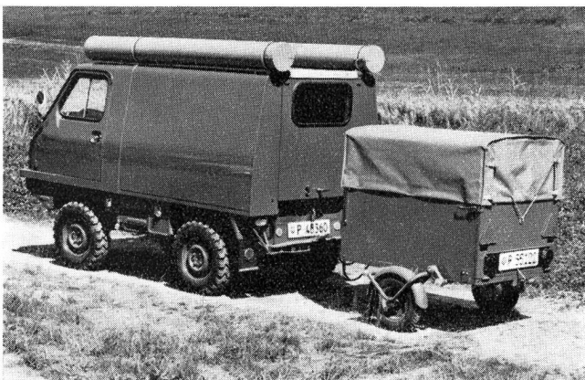
Fig.31 Geländegängiges Fahrzeug («Haflinger») für Kleinkoaxialkabel-Spleissgruppen. Der Anhänger enthält die Ausrüstung zur Signalisierung von Baustellen an Strassen
