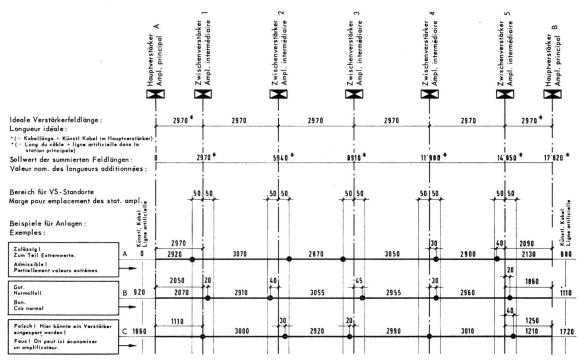
Fig. 12 Verstärkerfeldlängen bei Kleinkoaxialkabelanlagen
