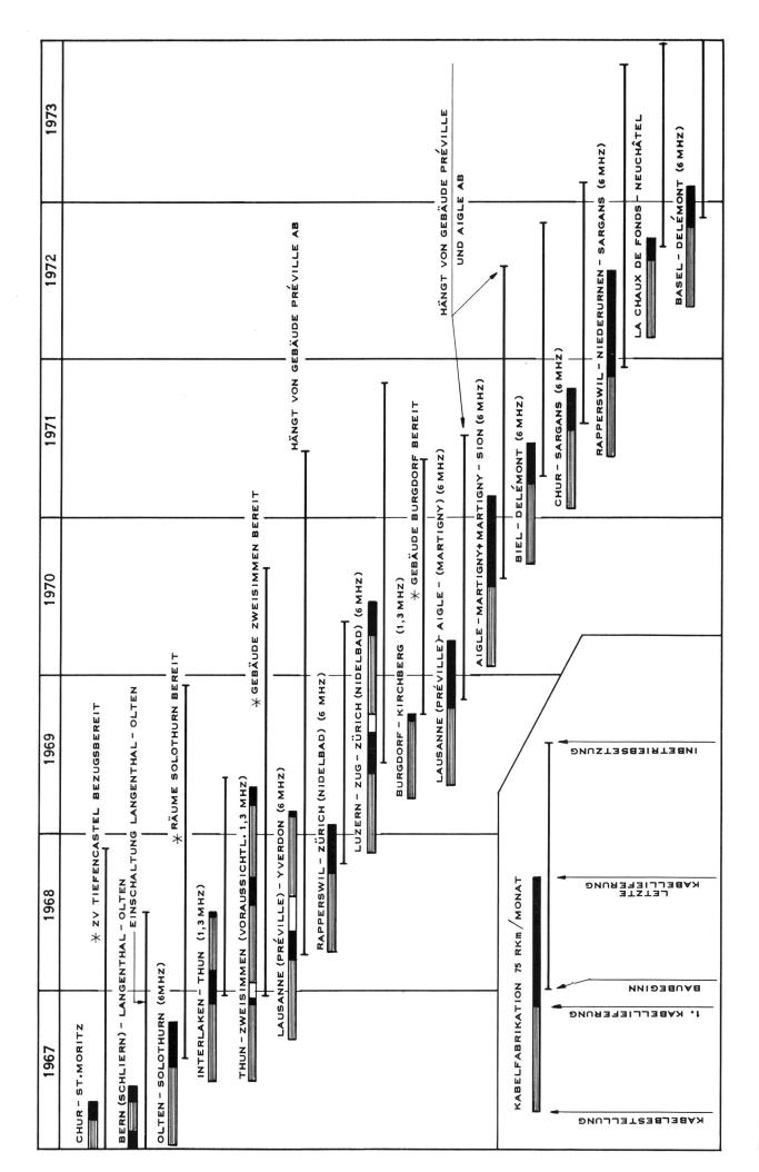
Fig. 11 Bauprogramm 1968 — 1972 der Kleinkoaxialkabelanlagen
