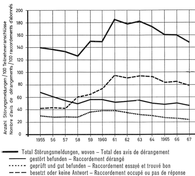
Fig. 10 Entwicklung der Störungsmeldungen. Schweizerische Durchschnittswerte je 100 Teilnehmeranschlüsse und Jahr Evolution du nombre des avis de dérangement. Moyennes suisses par 100 raccords d'abonnés et par année
