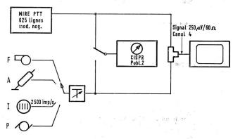
Fig.1 Principe du dispositif d'essai
