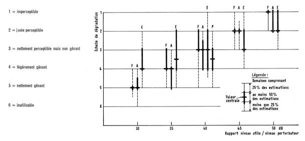
Fig. 2 Répartition des estimations de 20 observateurs jugeant la dégradation d'une image fixe de télévision perturbée par diverses sources, lorsque le niveau du signal utile est de 1000 pW (250  $\mu$ V en 60 ohms). F = sèche-cheveux, A = aspirateur, E = générateur d'impulsions «Empire» IG 102, P = moteur d'horlogerie Patek-Philippe
