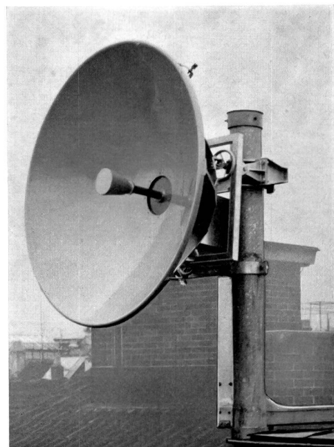
Fig. 4 7-GHz-Strahleinheit eingesetzt in 1,75-m-Parabolspiegel
