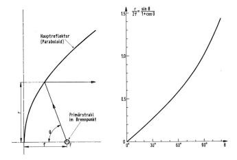
Fig. 1 Klassische Parabolantenne: geometrische Zusammenhänge
