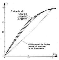
Fig. 4 Abbildungsgesetz zwischen  $\Theta$  und r für gewünschte Ausleuchtung in der Öffnungsebene mit (r $_{\rm 3}/r_{\rm 20})=0,\!85$
