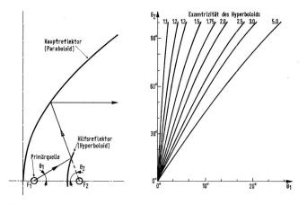
Fig. 2 Cassegrainantenne: Abbildungsgesetz zwischen  $\Theta_{\rm 1}$  und  $\Theta_{\rm 2}$
