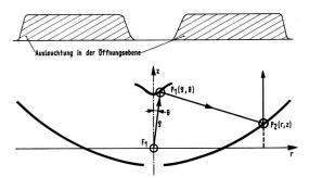
Fig. 3 Allgemeine rotationssymmetrische Antenne: Strahlengang in einer Meridianebene
