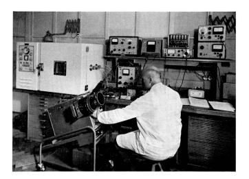
rry. i Messungen an elektronischen Schaltungen. Die Prüflinge befinden sich im Klimaschrank (links)
