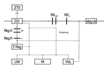
Fig. 9 Prinzip des teilelektronischen Fern-Ausgangsamtes A60
