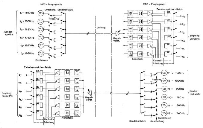
Fig. 8 Prinzip einer Mehrfrequenz-Code-Wahl-Ausrüstung im 4-Draht-Betrieb
