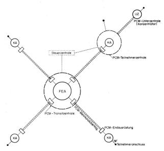
Fig. 3 Integriertes PCM-System
