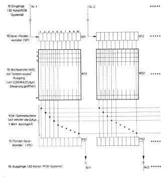
Fig. 4 Durchschalteeinheit für 15×15 = 225 PCM-Sprachkanäle (ankommender Verkehr = ungerade Kanäle)
