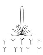
d) Durch eine nicht homogene Energieverteilung auf die Einzelstrahler oder durch ungleichmässige Abstände derselben gelingt eine Reduktion der Seitenlappen, jedoch nicht im gleichen Masse wie bei Figur 3a.
