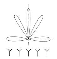
b) Richtdiagramm eines Reihen- oder Gitterstrahlers: ein Bündel fast gleicher Keulen; die mittlere hat praktisch gleiche Form wie die Hauptkeule von Figur 3a.
