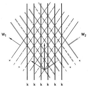
Fig. 11 Die Überlagerung von zwei sich kreuzenden Wellen  $W_1$  und  $W_2$  (eingezeichnet sind die Wellenfronten bei positiven und negativen Maxima der Feldstärke) ergibt ein Interferenzfeld mit Knotenlinien k (Knotenflächen im dreidimensionalen Fall). Zwischen den Knotenlinien (allgemeiner: Intensitätsminima falls die Wellenamplituden nicht gleich sind) scheint sich die Interferenzstruktur in der Summenrichtung fortzubewegen
