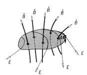
Fig. 2 Integralform des Induktionsgesetzes: Die zeitliche Änderung des magnetischen Flusses (Flächenintegral von d $\boldsymbol{B}/\mathrm{d}t$ ) ist gleich dem negativen Linienintegral der elektrischen Feldstärke  $\boldsymbol{E}$  längs des Randes
