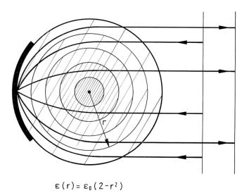
Fig. 5 Die Luneberglinse (mit inhomogenem Dielektrikum) teilweise mit sphärischem, metallischem Reflektor versehen, wirkt als rückrichtende Antenne.  $\varepsilon(r)=\varepsilon_{\rm o}$  (2- $r^2$ )
