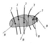
Fig. 1 Zusammenhang zwischen der Durchflutung (Flächenintegral der Stromdichte **J**) und der magnetischen Umlaufspannung (Linienintegral der magnetischen Induktion **B** über den Rand der Fläche)
