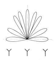
c) Wie Figur 3b, aber weniger Elementarstrahler: je weniger die Antennenfläche besetzt ist, desto mehr Keulen treten auf.
