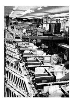
Fig. 1 Die Codierplätze, das 10-Rinnen-System und die Sortiermaschine der Briefverteilanlage in Bochum
