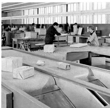
Fig. 1 Office de dépôt. Guichets des colis, avec départ de trois rubans transporteurs: de gauche à droite, le ruban pour les envois exprès, le ruban pour les colis hors sac et le ruban pour les colis en sac
