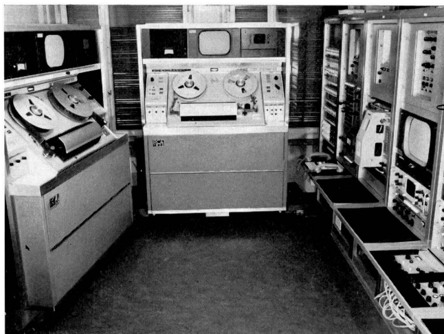
Fig. 5 Blick in den Apparateraum mit zwei Magnetaufzeichnungsanlagen, Bildendkontrolle und Dia-Abtaster. Auf dem Bilde nicht sichtbar: Ein 16-mm-Filmabtaster Vidikon und eine Perfoaschine 16 mm, verkoppelt mit Selsyn. Platzreserve für zweiten Abtaster ist vorhanden
